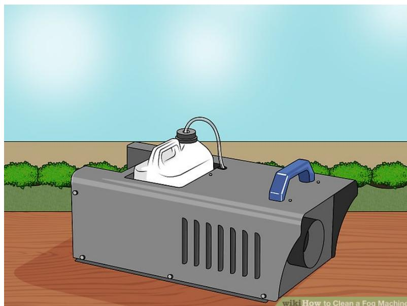
**2. Слейте воду из резервуара дым машины.** Снимите бак с машины. Отвинтите крышку и слейте оставшуюся жидкость для дыма в раковину или в другую емкость. Раствор уксуса поможет вам очистить резервуар.
