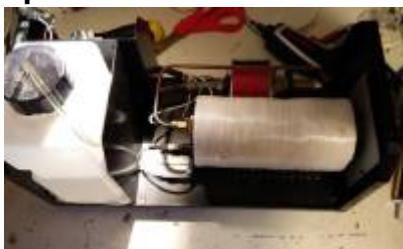
Вторая проблема возникает из-за перегрева ТЭНа. Он встречается реже, но также приводит к «закоксовыванию» камеры м. Такая неисправность встречается в основном у дешевых генераторов. Помимо вероятности более быстрого выхода из строя дымогенератора, перегрев обогревателя приведет к выходу неприятного «**пригоревшего**» запаха дыма. Основная причина этого - неправильная настройка / калибровка теплового реле дымогенератора, регулирующего температуру нагрева в камере.
