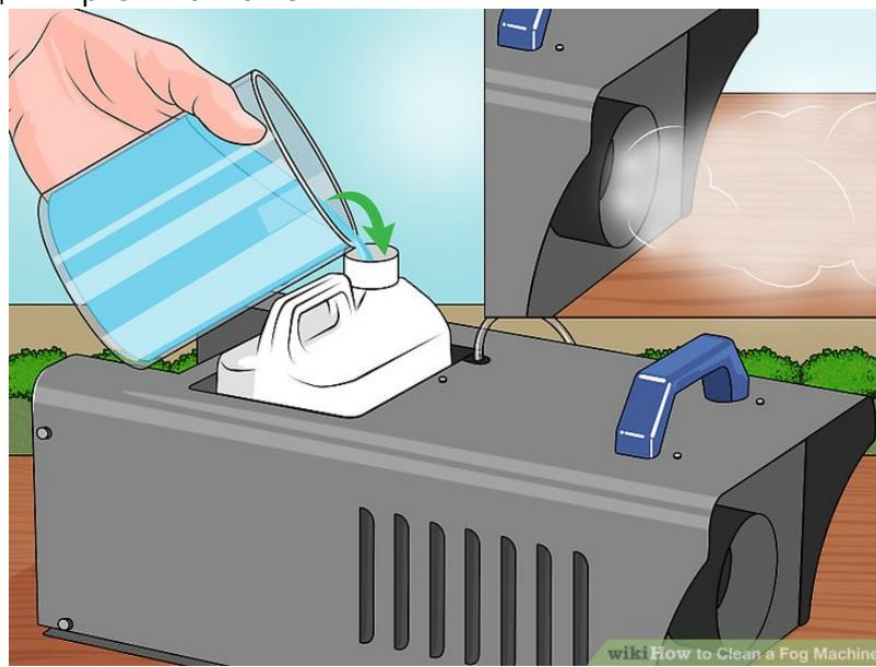
4. Слейте жидкость для чистки в отдельную емкость. И залейте в бак **дистиллированную воду без уксуса**. Прогоните дистиллированную воду 2-3 минуты через дым машину.
