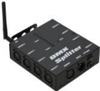
Рассмотрим небольшой бюджетный но за свои деньги хорошо собранный сплиттер<sup>1)</sup> сигнала DMX, для подключения вращающихся голов, сканеров, диммеров, и других приборов управляемых по DMX 512. Одним из больших плюсов этого сплиттера - компактность, его можно компактно убрать к себе в сумку ,и много места он не занимает.
