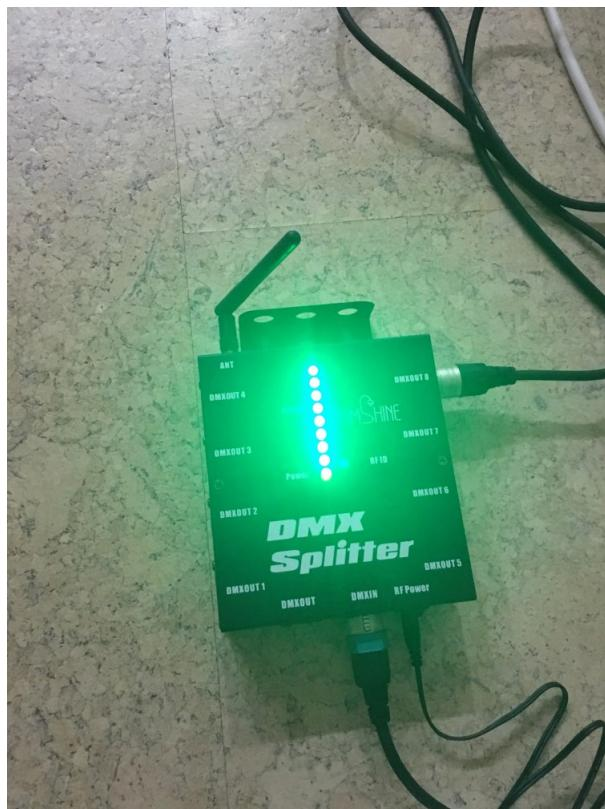
Расстояние приема заявлено 300-400 метров прямой видимости, на самом деле максимальное рабочее расстояние **100 метров максимум**. На корпусе расположен индикатор уровня приема сигнала.
