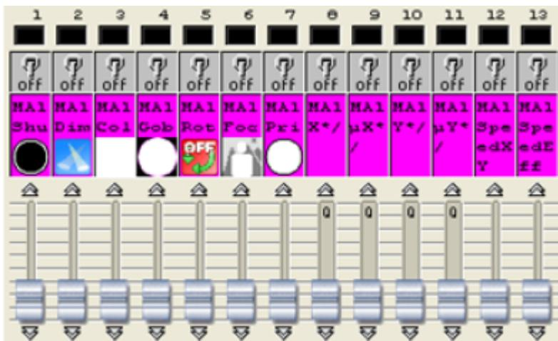
В данном случае наш прибор имеет 13 каналов управления. Его поле выделено **одним цветом**
