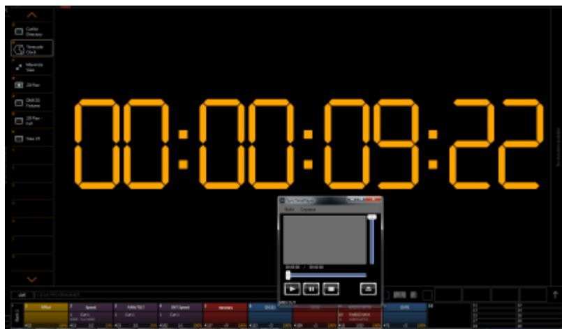
Синхронизация МТС Timde code с программой Martin M-PC. MP-C таймкод принимает корректно.
