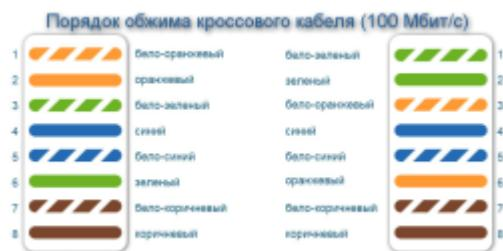
А на втором конце кабеля используется следующая последовательность цветов:
