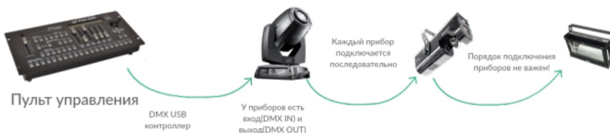
Схема построения DMX 512 сети используя пульт управления
