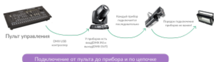
Схема построения DMX 512 сети используя пульт управления
