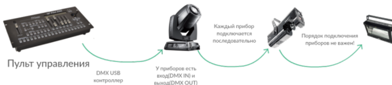
Схема построения DMX 512 сети используя пульт управления
