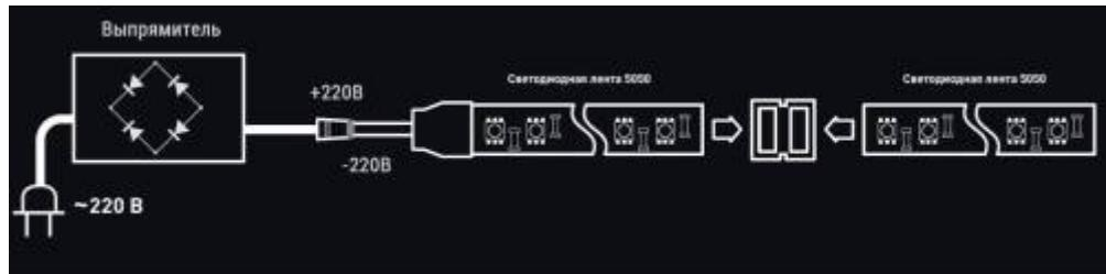
Резать можно только кратно 50 или 100 см. Когда в линии выходит из строя один светодиод, то выключается сразу большой отрезок, равный размеру нарезки.
