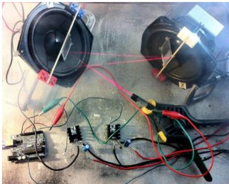
Собрать устройство не составляет большого труда, в основном большинство компонентов найдется у каждого(кроме [Arduino](#), ее можно заказать на [Aliexpress](#)). С помощью гальванометров - динамиков можно создавать красивые фигуры, писать любой текст и даже воспроизводить небольшие анимации и картинки.
