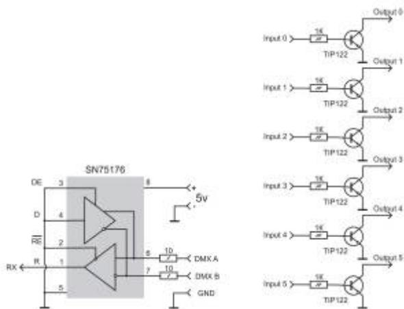
Сигнал управления с разъема DMX подается на микросхему буфера SN75176, а с нее - на вход RX микроконтроллера Arduino. После обработки и дешифровки сигнала (если переданный по шине адрес соответствует заранее установленному адресу микроконтроллера) сигналы с выходов микроконтроллера подаются на транзисторные ключи.
