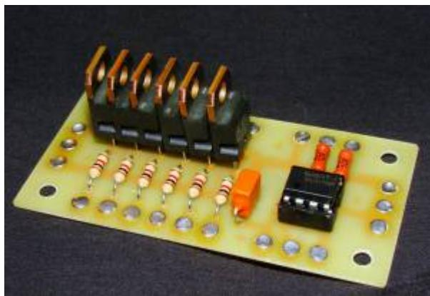
Ключи управляются выводами микроконтроллера Arduino с широтно-импульсной модуляцией (PWM), нагрузкой служат светодиодные светильники или светодиодная лента.
