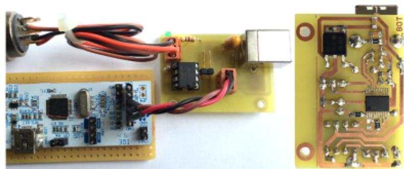
Выбор класса USB на стороне хоста между MIDI и виртуальным COM-портом осуществляется с помощью перемычки на разъеме SWD (перемычку можете заменить на переключатель).
