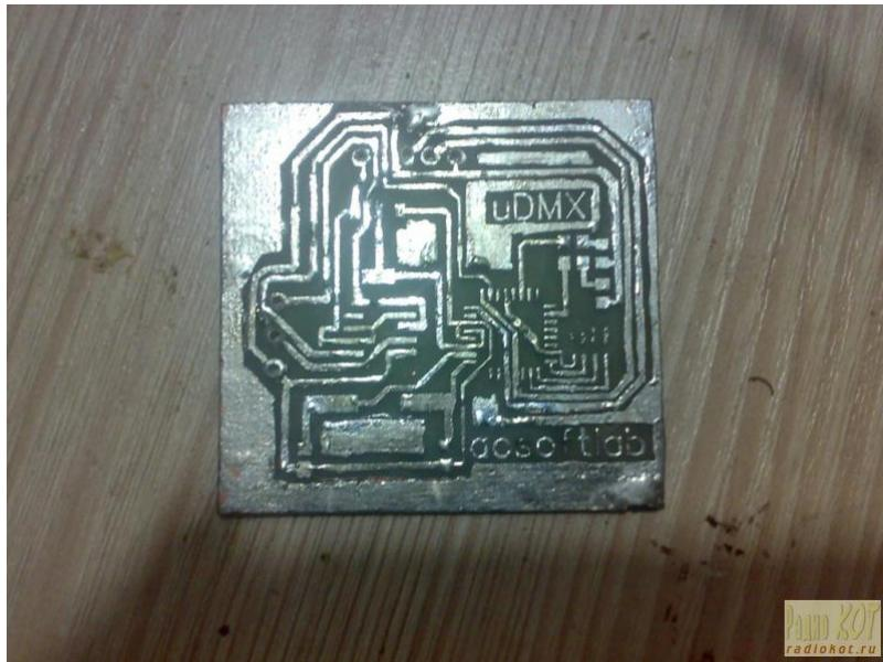
Хорошо! Далее берем все подготовленные ранее детали, и припаиваем на места. <WRAP center round important 60%> Только осторожно! Не замкните ноги на микросхемах, как сделал я. В итоге не мог прошить контроллер, пока под лупой не нашел кляксу. </WRAP>
